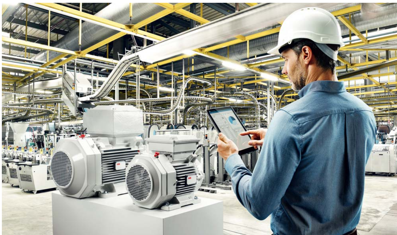
Le Smart Sensor de la taille d'un paquet de cigarettes peut être utilisé pour des moteurs électriques neufs ou existants.
