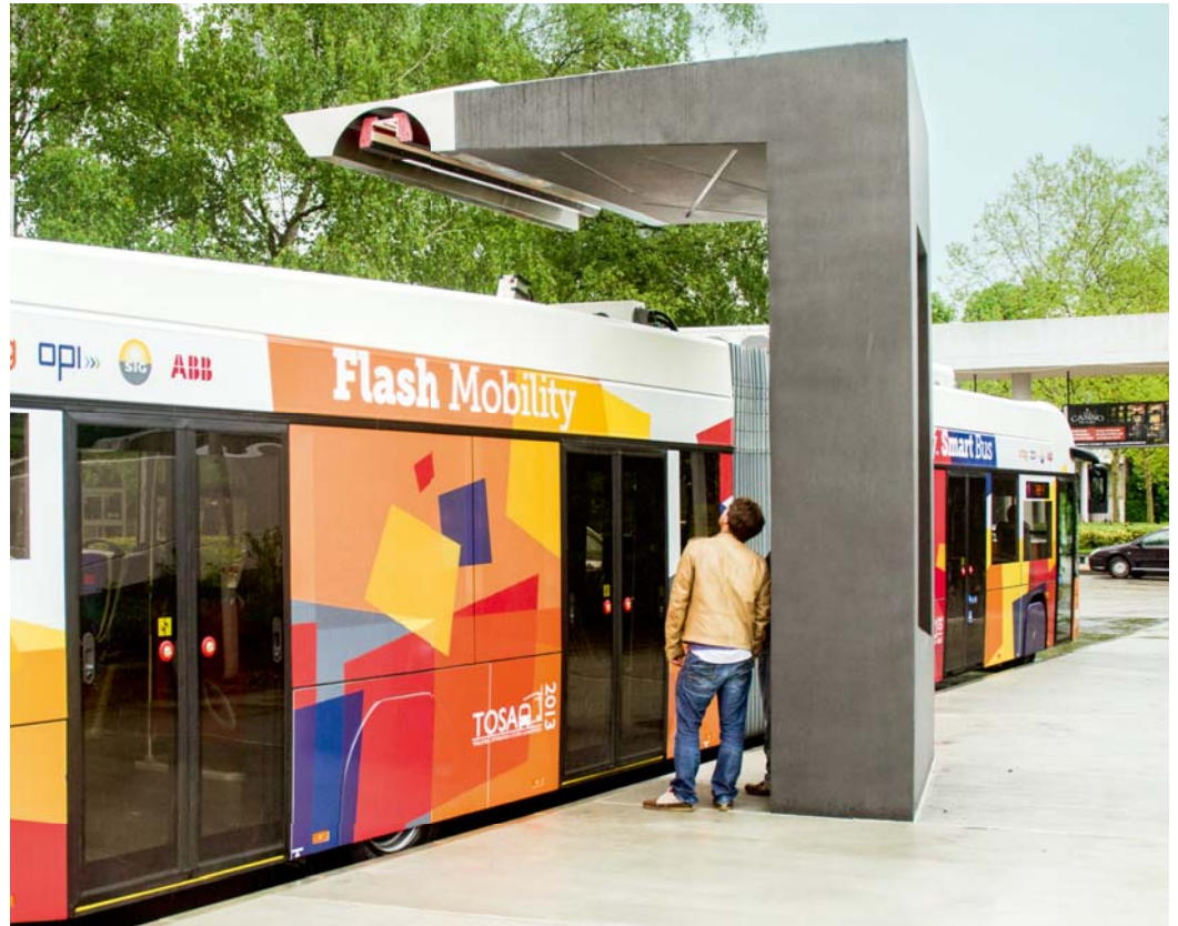
Le TOSA est rechargé en 15 s sur les postes de recharge intermédiaires équipés à cet effet.
