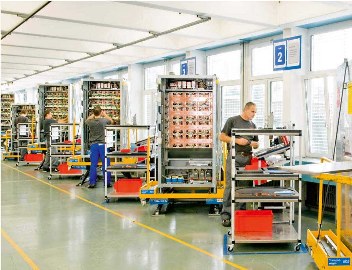
Fabrication cadencée de convertisseurs de fréquence à Turgi.
