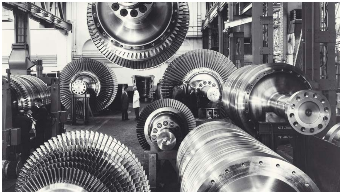
Le carnet de commandes en 1967 était plein, comme en témoigne l'atelier plein à craquer à Birr. Des rotors destinés à des turbines à vapeur et à gaz, prêts pour le montage final.
