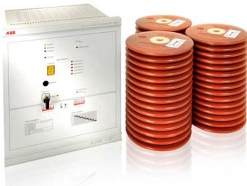
L'interrupteur de mise à la terre ultra-rapide UFES associe une unité électronique avec les éléments de commutation primaires correspondants. En cas de défaut, l'UFES établit une mise à la terre triphasée en moins de 4 ms.
