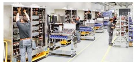
Fabrication à la chaîne de convertisseurs de traction à Turgi.
