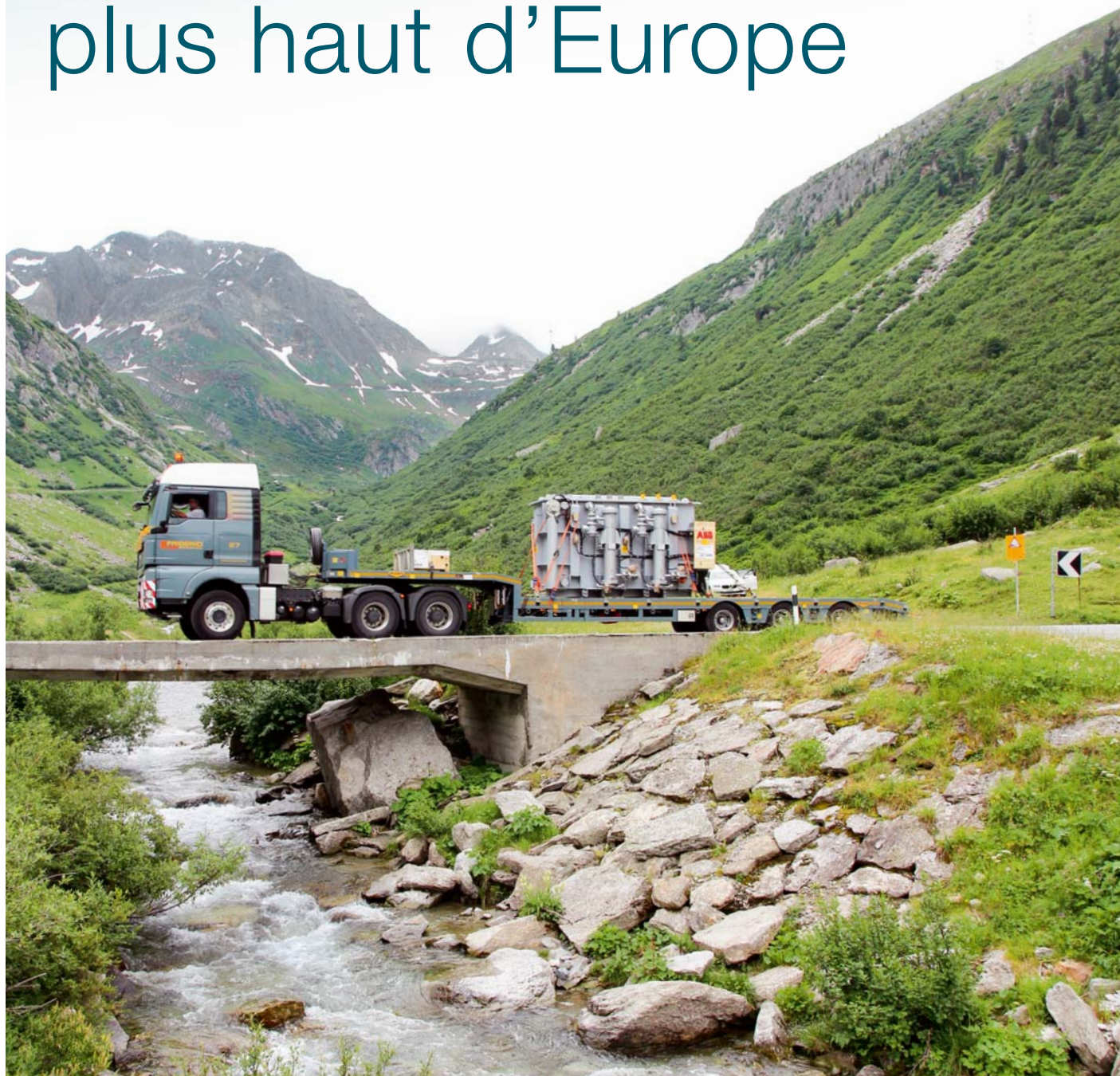
Le transformateur de 36 t sur le point d'arrivée sur le col du Nufenen.
