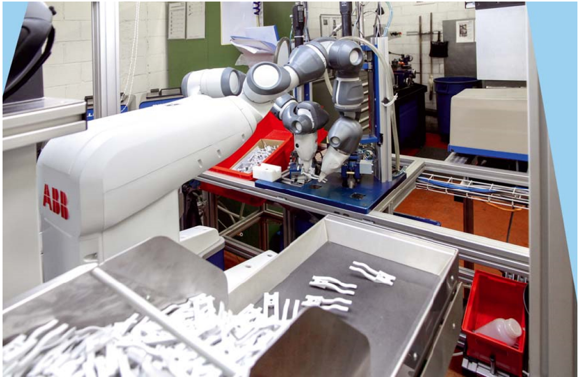
— Le YuMi au travail à Sirmach. Les petites pièces lui sont amenées sur un tapis vibrant. La caméra intégrée à la pince lui permet de savoir comment saisir les pièces.
