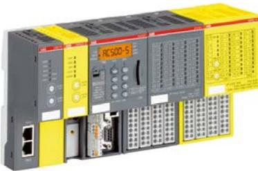
Des commandes connectées en réseau transmettent des données de processus et de sécurité entre plusieurs équipements.
