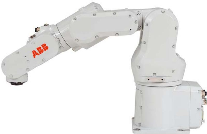
L'IRB 1100 est le tout dernier petit robot d'ABB. Il enregistre la plus grande capacité de charge de sa catégorie avec 4 kg. Le robot réduit les temps de cycle jusqu'à 35% et offre une répétabilité exceptionnelle. Il surpasse tous les robots comparables en termes de capacité de charge et de répétabilité de position.
