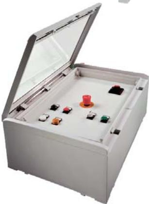
Les deux séries SR1 et Gemini viennent logiquement compléter le portefeuille d'armoires de commande d'ABB. Les boîtiers muraux SR1 sont en inox et sont disponibles dans 22 tailles différentes avec une hauteur maximale de 1000 mm. Avec les armoires de commande Gemini, ABB utilise pour la première fois dans le domaine électrotechnique le procédé de coulage par injection.
