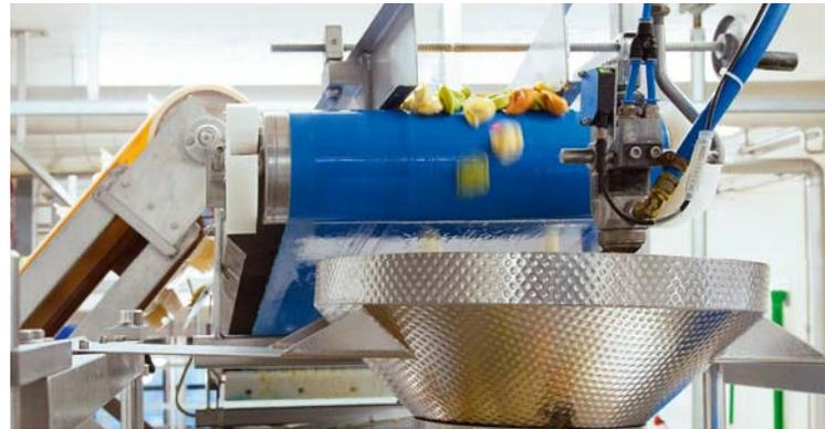
— Tubes ondulés d'ABB dans la production de tortellini: ils sont faciles à nettoyer et peuvent résister à des mouvements rapides et continus, même avec de petits rayons de courbure.
