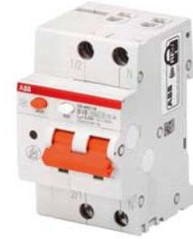
L'AFDD avec FI/LS est conçu avec une protection unipolaire et une commutation bipolaire pour un courant assigné de 6 à 20 A en caractéristique B ou C.
