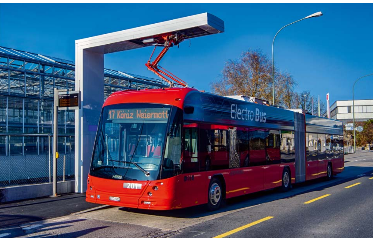
— Les bus électriques de la ligne 17 à Berne se réapprovisionnent en énergie à un poste de recharge rapide d'ABB au terminus. L'opération est réalisée avec un pantographe qui descend du poste.
