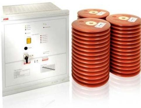
L'interrupteur de mise à la terre ultra-rapide UFES associe une unité électronique avec les éléments de commutation primaires correspondants. En cas de défaut, l'UFES établit une mise à la terre triphasée en moins de 4 ms.
