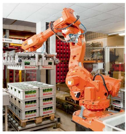
Un IRB 6600 à six axes d'ABB est utilisé chez Müller Bräu pour palettiser les caisses de
