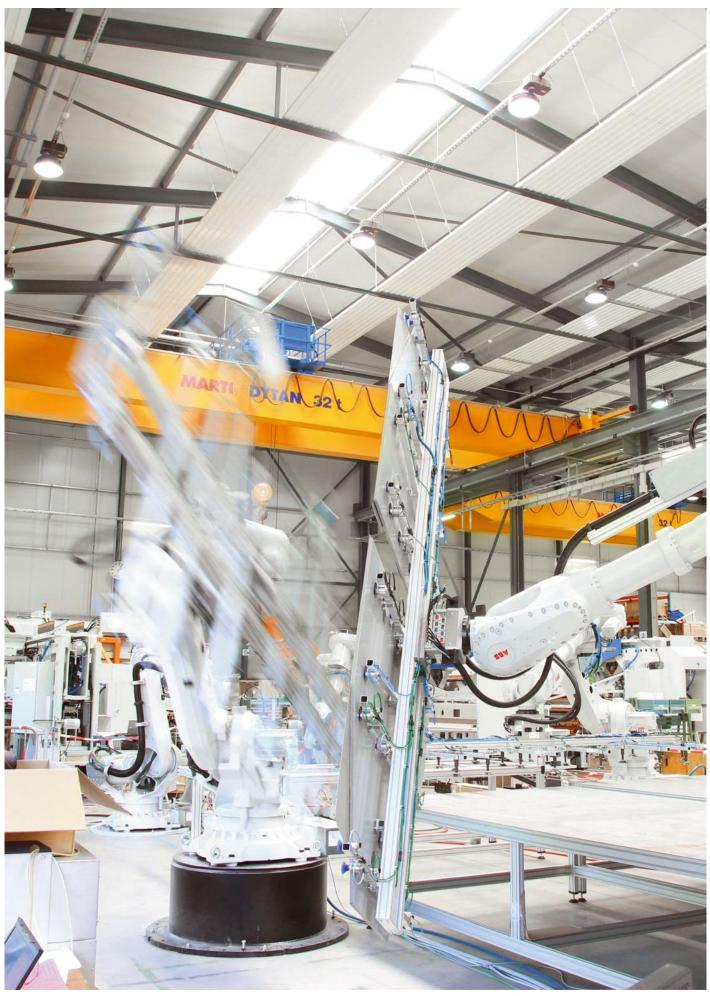
Interaction dynamique des huit robots ABB intégrés à la fabrication des flans.
