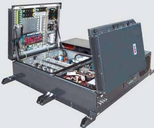
Le BORDLINE CC400 destiné aux véhicules ferroviaires légers transforme la tension du réseau de courant continu de 600 V ou 750 V en puissance d'entraînement pour la commande et l'alimentation
