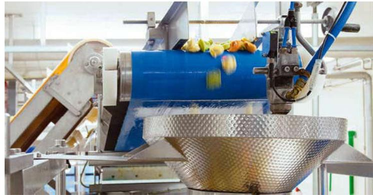
Les tubes ondulés d'ABB dans la production de tortellini: ils sont faciles à nettoyer et peuvent résister à des mouvements rapides et continus, même avec de petits rayons de courbure.
