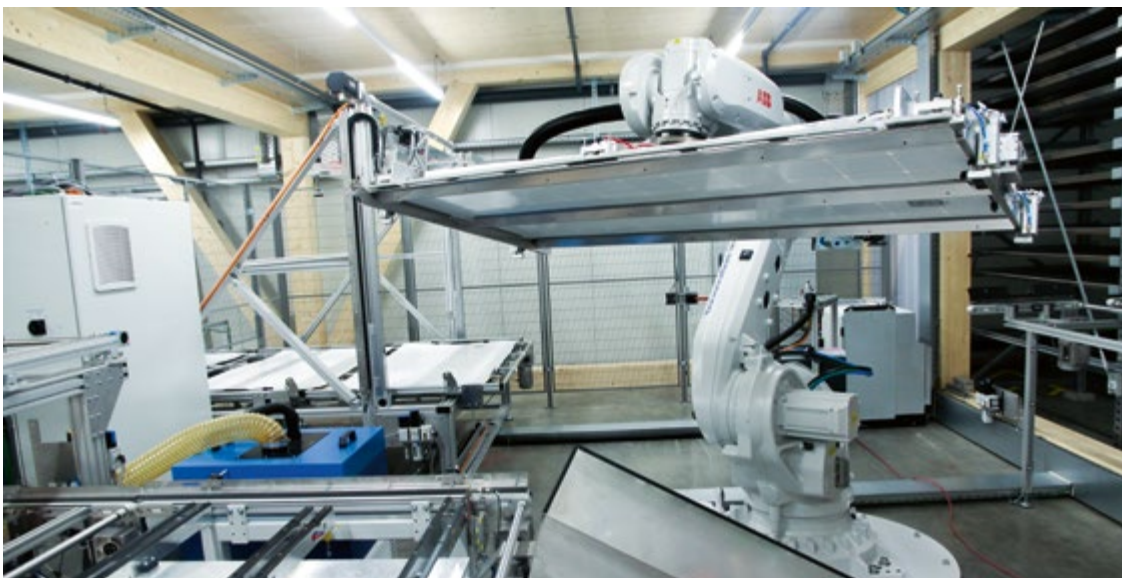
Le robot industriel IRB 6700 d'ABB colle les modules photovoltaïques au cadre en acier chromé de manière entièrement automatique.
