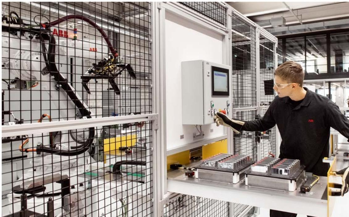
— La cellule robotisée de soudage des éléments de batterie en modules de batterie constitue le cœur de la nouvelle chaîne de production à Baden.
