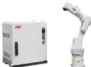
Le petit robot IRB 1100, piloté par la nouvelle commande OmniCore-C90XT, est désormais adapté aux conditions d'environnement les plus exigeantes grâce à sa protection IP67. Tous les composants électriques sont spécialement protégés afin que l'eau et la poussière ne puissent pas pénétrer dans le robot.
