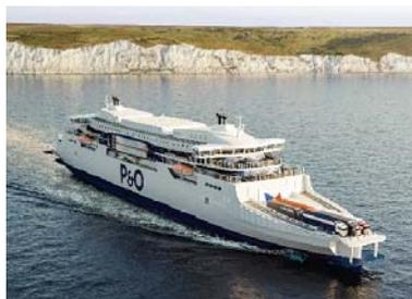
longueur de 230 mètres seront équipés de quatre systèmes de propulsion Azipod d'une puissance de 7,5 MW chacun. La mise en service est prévue pour 2023.
