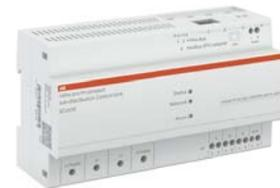
La Control Unit mesure, surveille et commute jusqu'à 96 circuits finaux. Elle dispose d'un tableau de bord intégré accessible par IP. En plus des capteurs, des appareils de mesure tels que le M4M peuvent être facilement intégrés via l'interface Modbus RTU.
