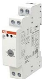
L'interrupteur crépusculaire TL active ou désactive les systèmes d'éclairage en fonction de la lumière du jour jusqu'à une charge totale de 800 W. La luminosité est mesurée par un capteur de lumière extérieur, résistant aux intempéries.
